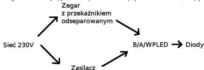
Rys. 8. Idea połączenia układu z zegarem czasowym.
